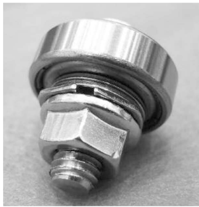
通常のベアリング、ワッシャー、ヨッシャー、通常のワッシャー、ヨッシャー、ナットの順でボルトを締結
